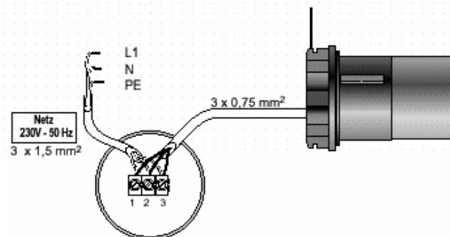
Чтобы избежать протекания воды в привод, рекомендуется закрепить головку привода выходом кабеля электропитания вниз.
